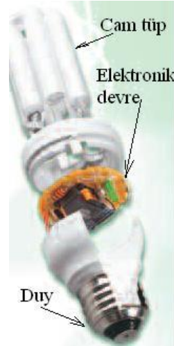
Şekil 4.5: Kompakt floresan ampul iç yapı resmi
