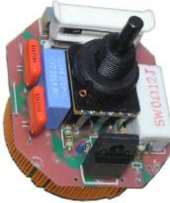
Resim 1.36: Dimmer anahtarın iç yapısı
