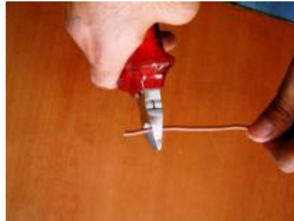
Resim 2.10: Kablonun yan keski ile soyulması
