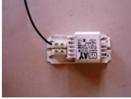
Resim 3.12: Balasta faz kablosunun bağlanması
