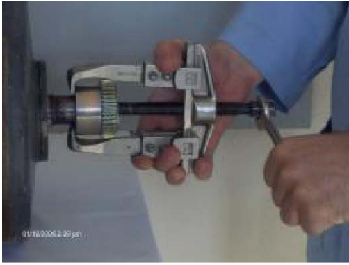
Resim 1.7: a-) Dişlinin çekirme ile sökülmesi
