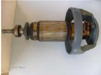
Resim 1.21: a) Endüvinin sökülmesi b) Kapağın endüviden sökülmesi
