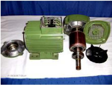
Resim 1.9: a-) Motorun parçaları çıkarılmış hali
