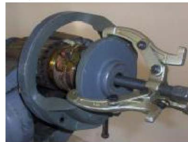
Resim 1.21: a) Endüvinin sökülmesi b) Kapağın endüviden sökülmesi
