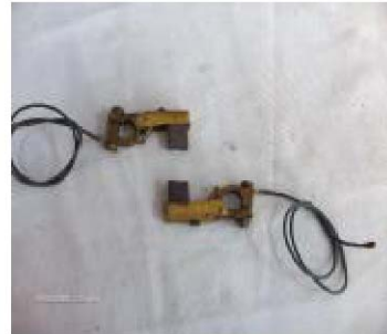
Resim 1.20: a-) Kapakların sökülmesi b-) Fırça tutucuların sökülmesi
