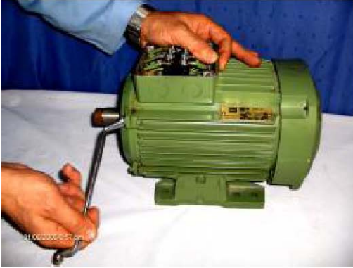
Resim 1.8: a-) Motor kapak cıvatalarının sökülmesi
