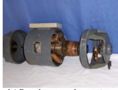
Resim 1.22: a-) Sökülmüş endüvi b-) Parçalarına ayrılmış motor Sökülen parçalar, bir kutu içerisinde toplanarak kaybolması önlenmiş olur.
