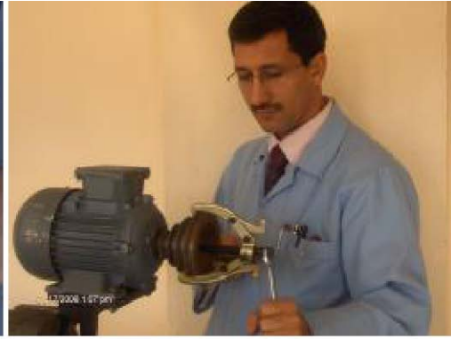
b-) Kasnağın çekirme ile sökülmesi
