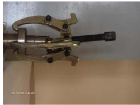
b-) rulmanın çekirme ile çıkarılması
