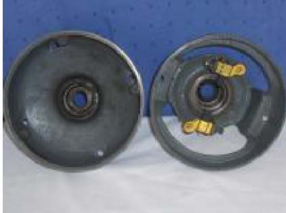
Resim 1.20: a-) Kapakların sökülmesi b-) Fırça tutucuların sökülmesi
