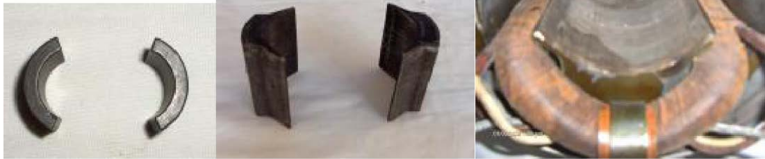
Resim 1.12: a-) Sabit mıknatıs b-) Sargısız kutup c-) Elektromıknatıs
