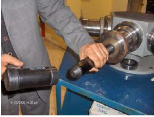
Resim 2.10: a) Pirinç boru ile çakma
