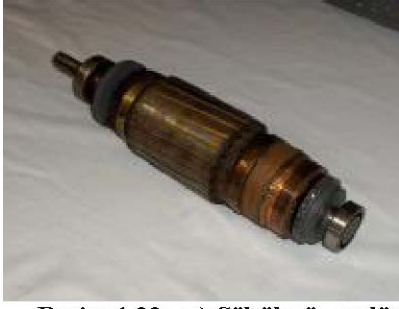
Resim 1.22: a-) Sökülmüş endüvi b-) Parçalarına ayrılmış motor Sökülen parçalar, bir kutu içerisinde toplanarak kaybolması önlenmiş olur.
